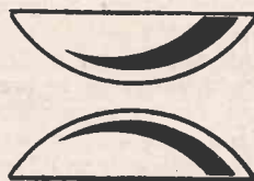
Fig. 5 - Chi intendesse utilizzare lenti positive, potrà realizzare l'oculare con due lenti piano-convesse (focale 20 mm. - diottrie + 40 cadauna). E' necessario che le lenti assumano la disposizione di cui a figura.
