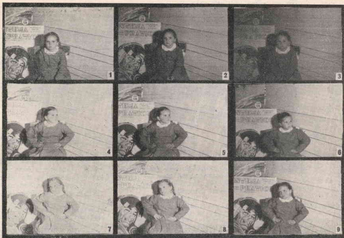
Fig. 9 - Per dare un punto di riferimento a coloro che intendessero realizzare il flash, eseguiamo 9 fotografie utilizzando capacità diverse. Per le foto 1, 2, 3 la capacità dei condensatori risultò essere di 160 mF.; per quelle 4, 5, 6 di 320 mF. e per le 7, 8, 9 di 480 mF. Nello specchio che segue, oltre alla capacità dei condensatori, sono state indicate le distanze in metri e le diaframme.
